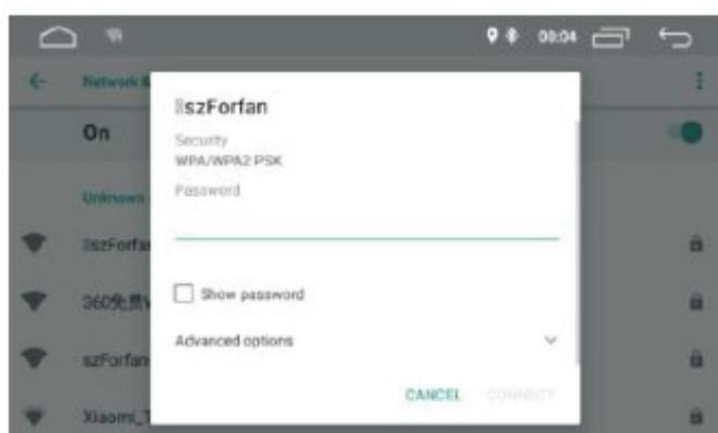
Podle výše uvedeného obrázku vyhledejte požadovaný hotspot Wi-Fi. Dokončete připojení Wi-Fi vložením hesla a stisknutím Připojit.
