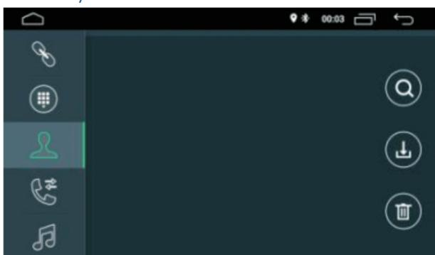
Zařízení podporuje synchronizaci kontaktů z mobilního telefonu do zařízení. Po připojení Bluetooth je připojeno, klepnutím na „“ stáhněte kontakty. Po dokončení stahování bude jméno kontaktu synchronizováno a zobrazí se na displeji během telefonního hovoru. Pro rychlý přístup ke kontaktům podporuje seznam kontaktů hledání jmen začínající první písmenem abecedy.
